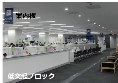
【南館3階の低突起ブロック】 案内板の青色を際立たせるため、カーペットと同じグレー色。照明により反射させ、光らせる。
