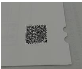
切り欠きを入れた音声 コードの例
