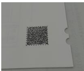
切り欠きを入れた音声 コードの例
