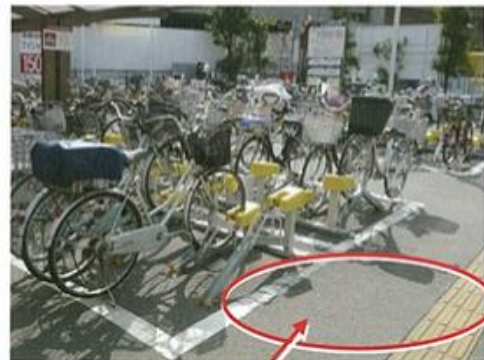
誘導ブロック上への駐輪を抑止するよう駐輪区画を見直している
