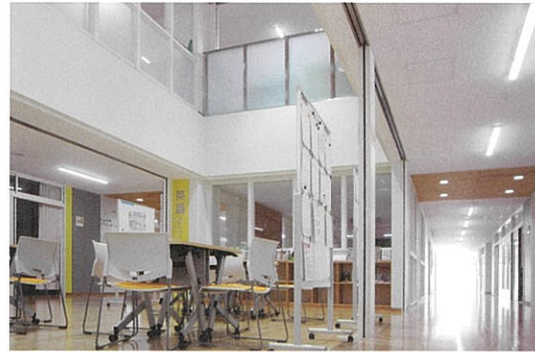
校内は見通しの良いダブルコリドー（二重廊下）になっており、各所に設けた吹抜けや光庭、テラスから差し込む光や風で明るく快適に過ごせる環境としている。
