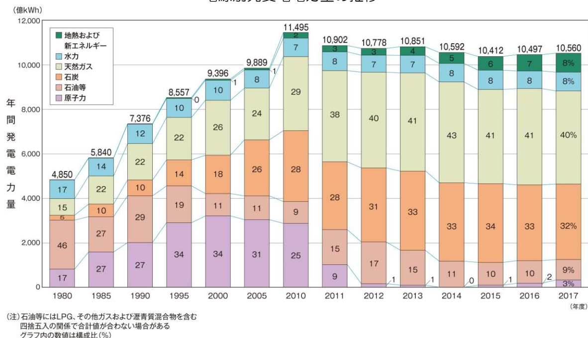
電源別発電電力量の推移
