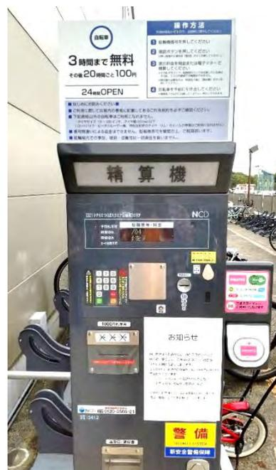
写真：非接触ICに対応した精算機
