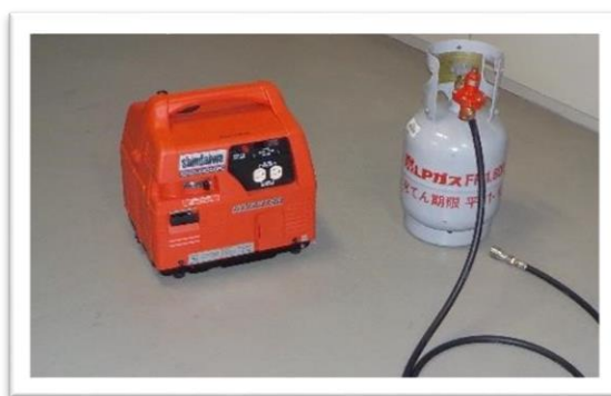
「備蓄物資（可搬型 LP ガス発電機と LP ガスボンベ）」
