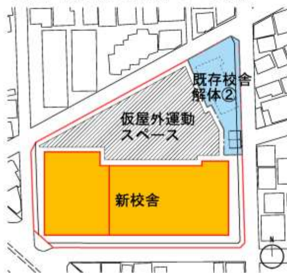
STEP4 既存校舎解体②+プール改修
