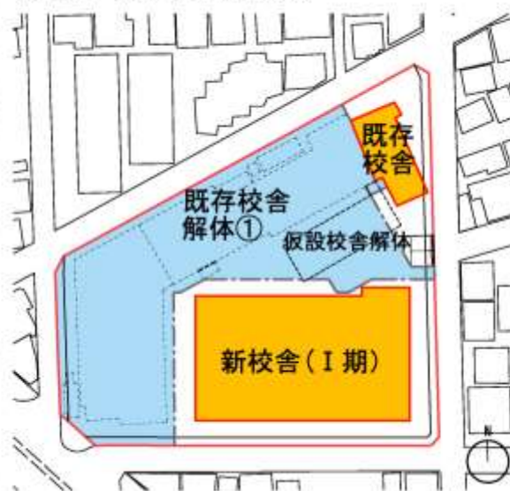
STEP2 既存校舎解体①
