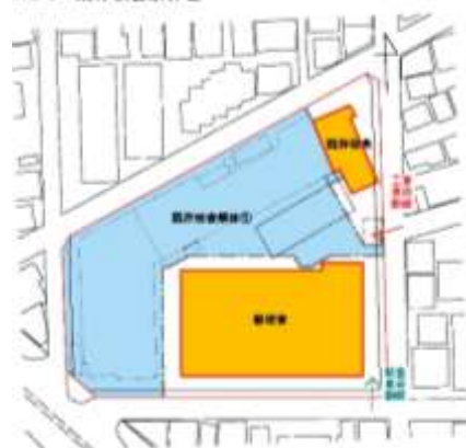
STEP2 既存校舎解体①
